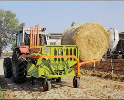
Il carico della paca avviene tramite una forca laterale, regolabile in larghezza (di serie).
