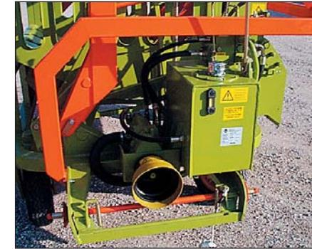
Funzionamento con centralina idraulica indipendente (di serie).
