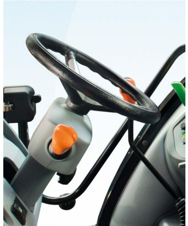
Das im Neigungswinkel verstellbare Teleskopenkrad kann beliebig an die Grösse des Fahrers angepasst werden.
